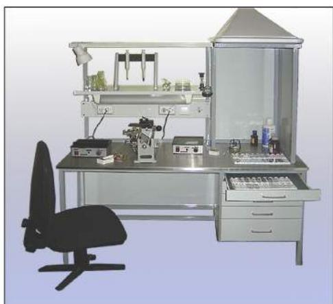
Создан с учетом традиционных отечественных технологий изготовления гистологических препаратов. Имеет полки для реактивов, принудительную вытяжку, блок розеток, стационарную лампу дневного света и точечный источник света с переменным углом освещения, выдвижные низкопрофильные ящики для гистологических препаратов и ящики для расходных материалов и инструментов.
