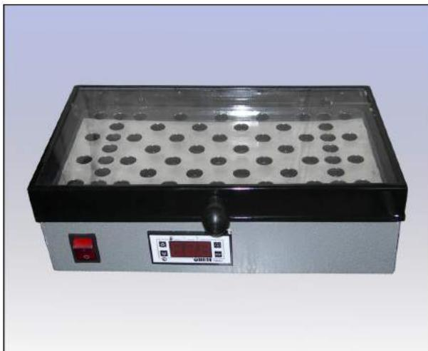
Предназначена для проведения иммуногистохимических реакций на парафиновых срезах на предметное стекло во влажной камере при температуре 37°C.
