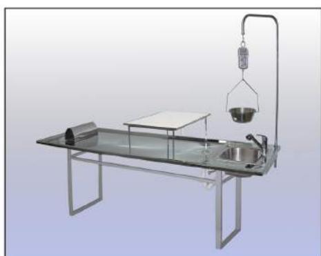
Рабочая поверхность изделия сплошная, по краям вертикальные бортики высотой 50 мм. В стандартной комплектации стол снабжен: мойкой, водопроводно-канализационным оборудованием (кран-смеситель, душ на гибком шланге от единого крана), совмещенным канализационным оборудованием (мойка + дренаж рабочей поверхности стола), столиком препаровочным (СП-5Б) с площадкой термопластовой с координатными линейками (ПТ-1), подголовником (П-1).
