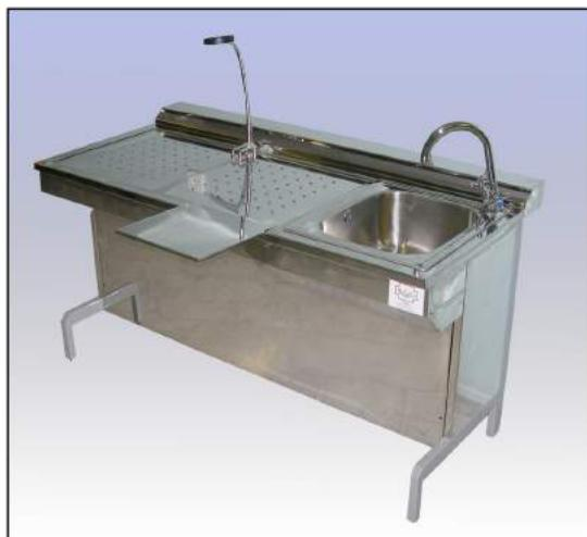
Основная конструкция является аналогом модели **СПВ-7Б**, но без верхней стойки с вытяжкой. В данной конструкции принудительная вытяжка производится только через отверстия рабочей поверхности вниз и щели задней стенки. Для обеспечения вытяжки с рабочей поверхности «вниз и назад» необходимо подключение к стационарной вентиляционной системе, либо установка дополнительного мотора.
