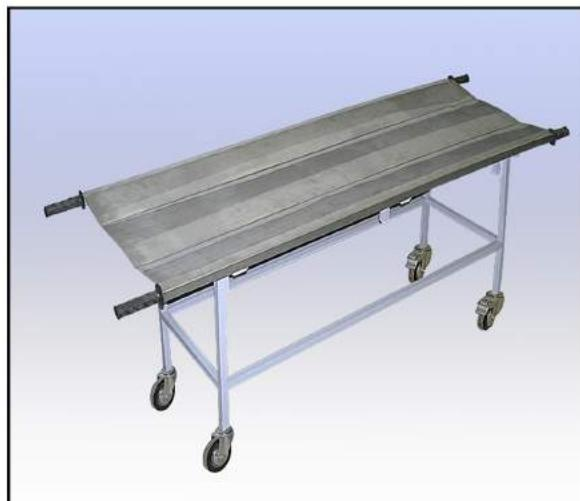
Каталка предназначена для перевозки и переноски трупов. Конструкция оборудована съемным лежаком из крашеного металла (**КСН-6б**), либо из нержавеющей стали (**КСН-6н**). Носилки имеют ножки 100 мм и вынимаются из стоек каркаса, что позволяет ставить их на пол. Колеса диаметром 200 мм с фиксаторами.
