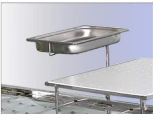
Предназначена для расположения инструментального набора во время вскрытия. Устанавливается на стойке в специальном отверстии в средней части боковой панели стационарного секционного стола серии (ССС-1). Стойка поворачивается вокруг оси и устанавливается в наиболее функциональном положении во время вскрытия. Площадка изготовлена в форме подноса с дренажными отверстиями.
